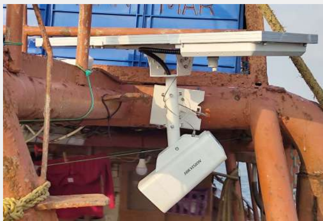
Cámara con panel solar a bordo de una embarcación pesquera en el Mar Rojo
